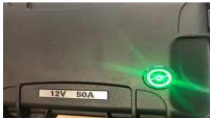
**Pour mettre en service votre sortie régulée, appuyer sur le bouton d'alimentation. Celui-ci s'allume en vert lorsqu'il est en service.**
