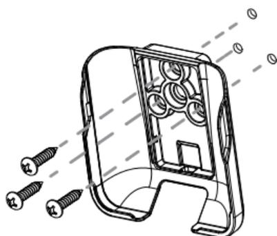
5. Fixez avec les attaches de votre choix. Utilisez un mastic d'étanchéité marin pour imperméabiliser les trous en cas de montage extérieur.
