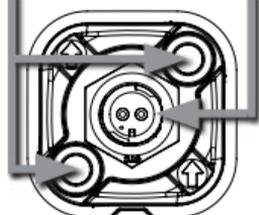
1. Utilisez la base de montage comme gabarit pour marquer la position des trous de montage et du trou du câble d'alimentation.
